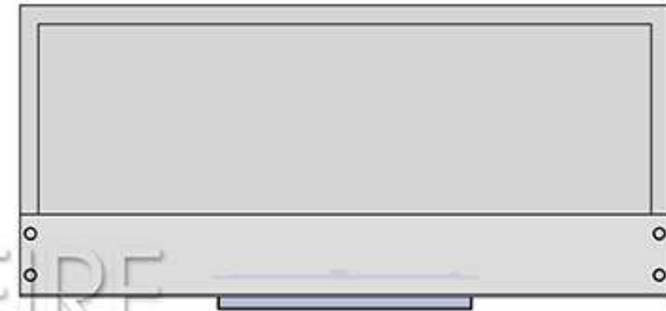
Расположение стекла на горизонтальных креплениях снаружи очага (при условии наличия рамки)
